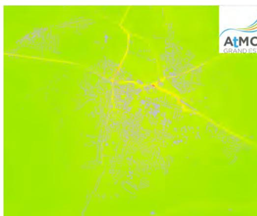
Tout comme pour la modélisation de  $\text{NO}_2$ , la modélisation de la moyenne annuelle en  $\text{PM}_{2,5}$  met en évidence les axes routiers qui traversent Épernay (RD 951, RD 3, RD 386 et RD 201). Les concentrations sont au-dessus des seuils recommandés par l'OMS.
